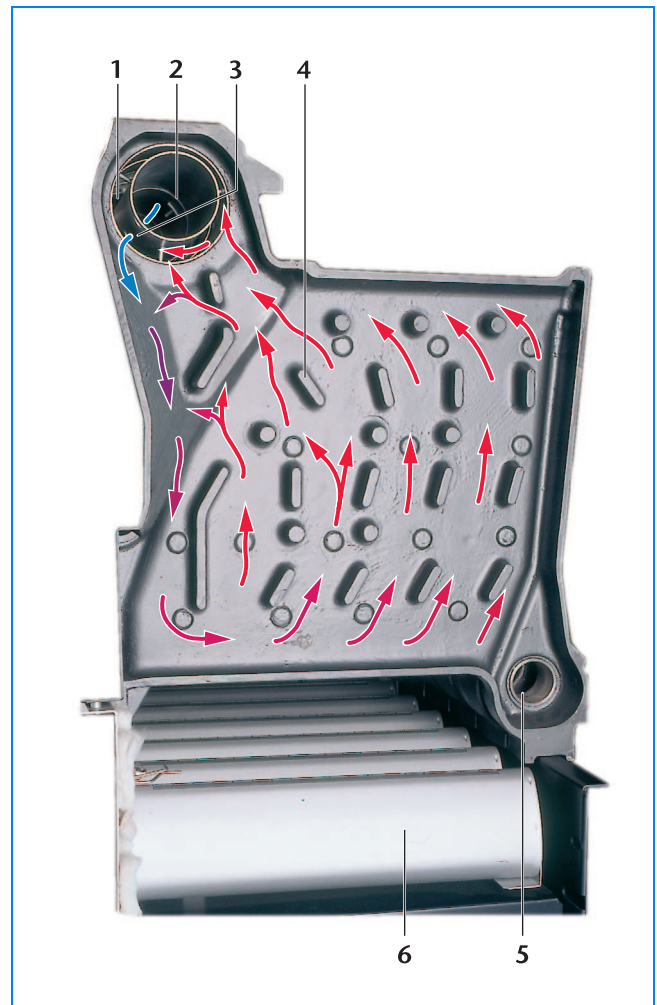
11/1 Распределение потока воды в секции котла Logano GE434 по принципу Thermostream (распределение воды в секции котла Logano plus GB434 происходит аналогично)
