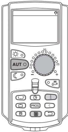
Отопительная установка может работать с несколькими отопительными контурами. Если требуется изменить комнатную температуру для отопительного контура, отличного от контура, выбранного в последний раз, то сначала выбирается нужный контур.
