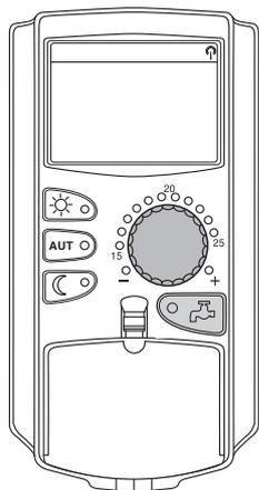
С помощью пульта управления можно экономично нагревать воду в контуре горячего водоснабжения. Для этого предусмотрено приготовление горячей воды по таймеру. Можно выбирать между заданной температурой горячей воды и "Выкл." для отключения приготовления воды для ГВС.
