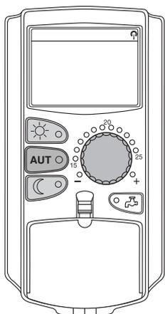
Ручкой управления при закрытой крышке можно задать комнатную температуру. При открытой крышке нажмите дополнительно кнопку "Дневной режим" или "Ночной режим".
