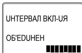
Когда выбрана точка включения следующего по времени отопительного периода, то в нижней строке появляются восемь ячеек, которые будут гаснуть слева направо с периодичностью в секунду. При исчезновении последней ячейки два отопительных периода будут объединены.
