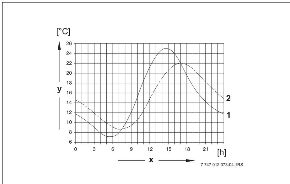
Рис. 15 Сравнение текущей и демпфированной температуры наружного воздуха
