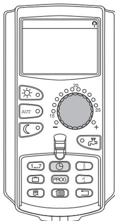
Отопительный период подразумевает два значения времени переключения: одного включения и одного выключения. Если отменяется отопительный период, то должны быть отменены обе точки.
