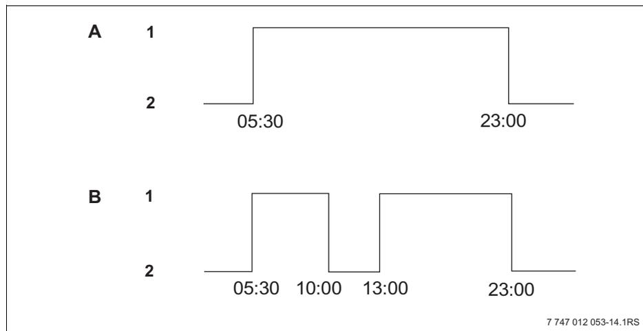
Рис. 16 Ввод точек переключения для прерывания периода отопления
