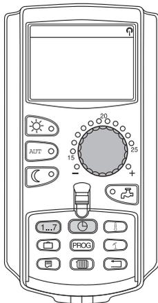
MEC2 имеет приемник радиосигнала, который при нормальных условиях приема постоянно контролирует и корректирует время в системе управления.
