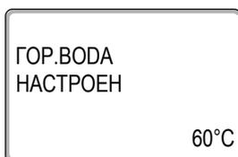
Удерживайте нажатой кнопку "Горячая вода" и ручкой управления установите нужную температуру горячей воды.
