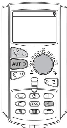
В системе управления Logamatic 4323 переключение с летнего режима на зимний и наоборот происходит с некоторым запаздыванием по времени, так как сигнал от датчика наружной температуры поступает уже с учетом аккумулирующей способности здания и его теплоизоляции ("демпфированная наружная температура", → рис. 15).
