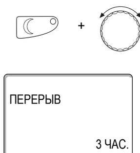
Удерживайте нажатой кнопку "Ночной режим" и **одновременно откройте крышку MEC2**. Функция "Перерыв" включена. Удерживайте нажатой кнопку "Ночной режим" и ручкой управления установите нужное количество часов (здесь: "3").
