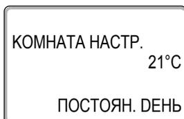
Загорается светодиод кнопки "Дневной режим". Теперь отопительная установка находится в постоянном дневном режиме (нормальное отопление).
