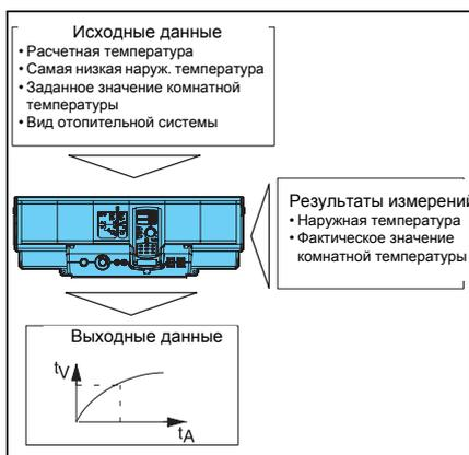
Благодаря функции адаптации и самооптимизации модульная система управления Logamatic 4000 в соединении с дистанционным управлением в контрольном помещении приводит отопительную кривую в соответствие с теплотехнической характеристикой здания.
