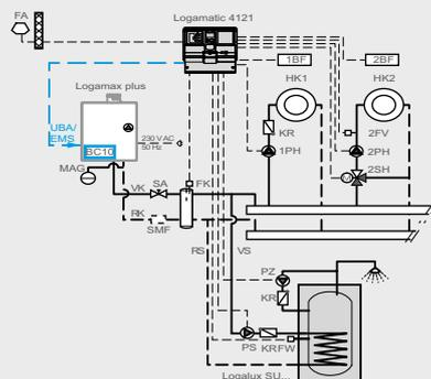
Приготовление горячей воды через загрузочный насос бака, вариант „Бак-4000“
