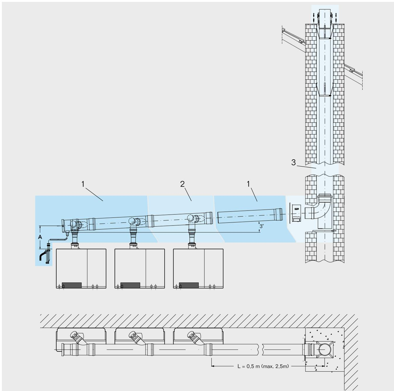
Поз. 1 Базовая комплектация системы дымоудаления из полипропилена PP для 2 котлов в каскаде состоит из:
