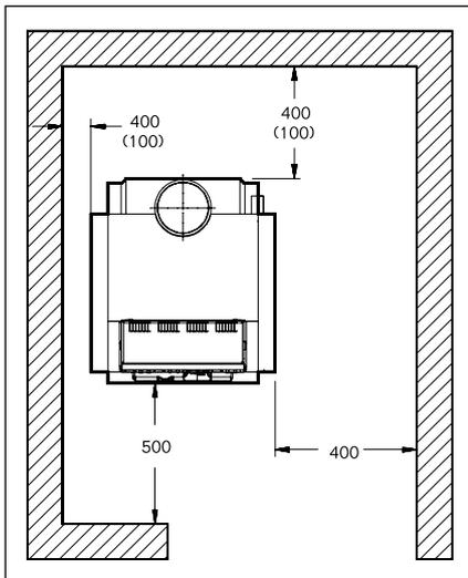
При установке отопительного котла следует соблюдать приведенные минимальные расстояния (указаны в скобках). Для удобства проведения монтажных, сервисных работ и технического обслуживания необходимо выдерживать рекомендуемые расстояния от стен.
