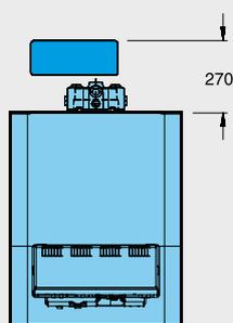
Максимальная высота с баком под котлом - 2028 мм, без бака - 1373 мм <sup>1)</sup>
