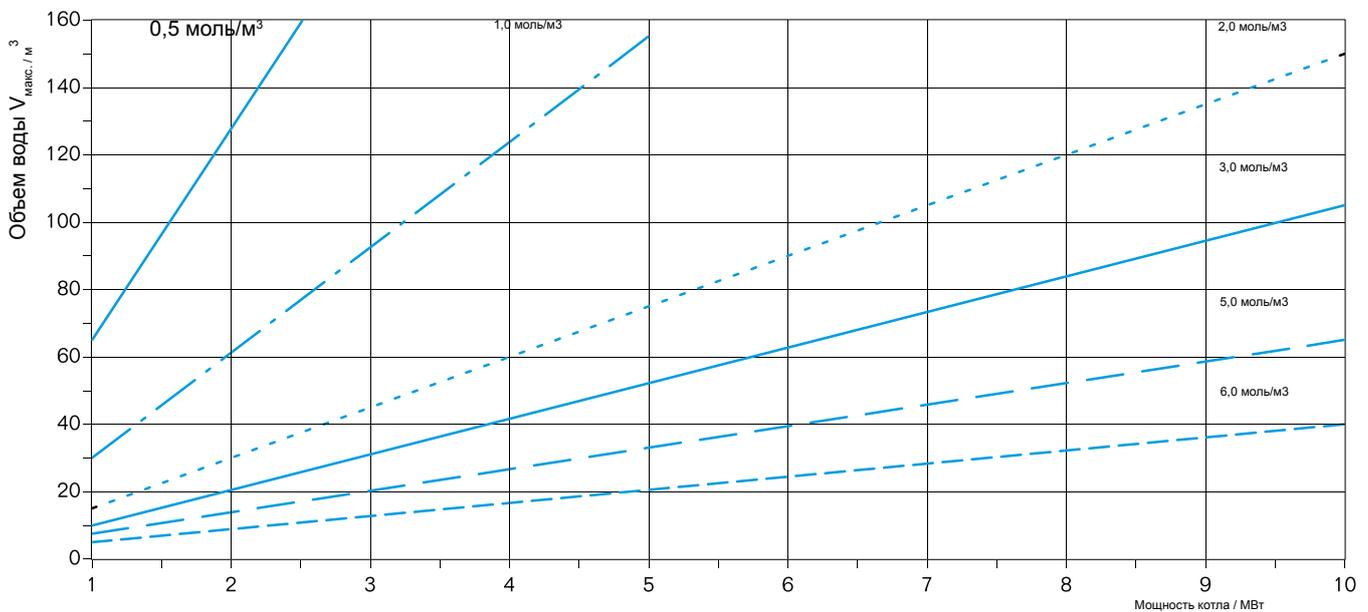
Расчетный объем воды  $V_{\text{макс}}$  для котлов  $\dot{Q} > 1$  МВт до  $\dot{Q} = 10$  МВт и различных концентраций  $\text{Ca}(\text{HCO}_3)_2$ , моль/м³
