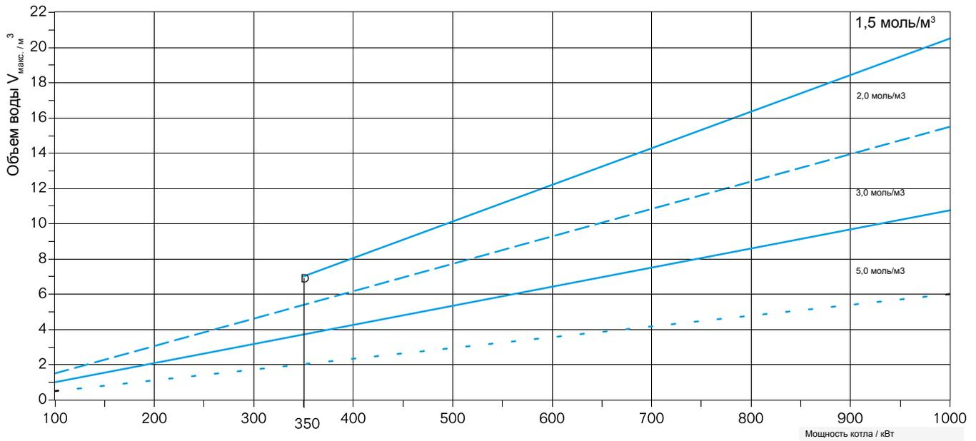
Расчетный объем воды  $V_{\text{макс}}$  для котлов  $\dot{Q} > 100$  кВт до  $\dot{Q} = 1000$  кВт и различных концентраций  $\text{Ca}(\text{HCO}_3)_2$ , моль/м³
