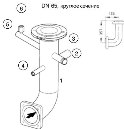
Диаметр трубы подающей линии DN 65, четыре грани
