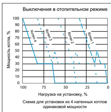
Такой принцип включения и выключения гарантирует полностью модулированный диапазон мощности каскада котлов, ми-
