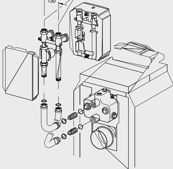
Подающая/обратная линии Rp1 для исполнения HS/HSM 25 и HSM 20; Rp1 1/4 для исполнения HS/HSM 32
