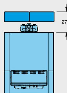
Максимальная высота с баком под котлом и с гребенкой НКV 2/32 - 2158 мм (HS/HSM 25, HS/HSM 20) и 2028 мм (HS/HSM 32). Максимальная высота без бака под котлом - 1503 мм (HS/HSM 25, HS/HSM 20) и 1553 мм (HS/HSM 32) <sup>1)</sup>
