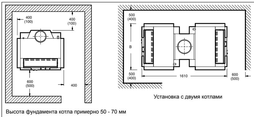
При установке отопительного котла следует соблюдать приведенные минимальные расстояния (указаны в скобках). Для удобства проведения монтажных, сервисных работ и технического обслуживания необходимо выдерживать рекомендуемые расстояния от стен.
