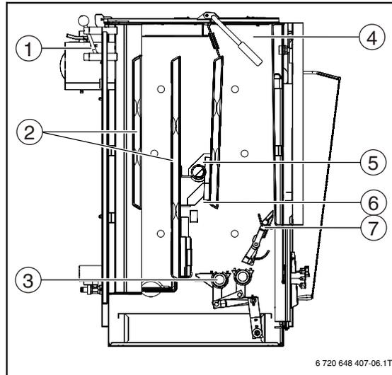
Рис. 2 Котёл в разрезе, здесь тип 24
