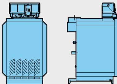
Настройка: заводская установка на природный газ Н, переналадку на сжиженный газ Р / В/Р осуществляет заказчик, используя детали для перенастройки (дополнительная комплектация)
