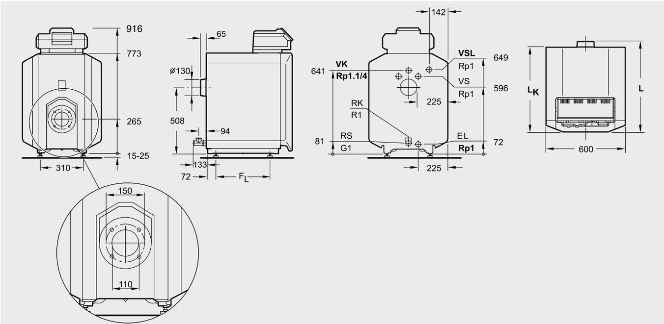
Размеры и подключения (приведены в мм)
