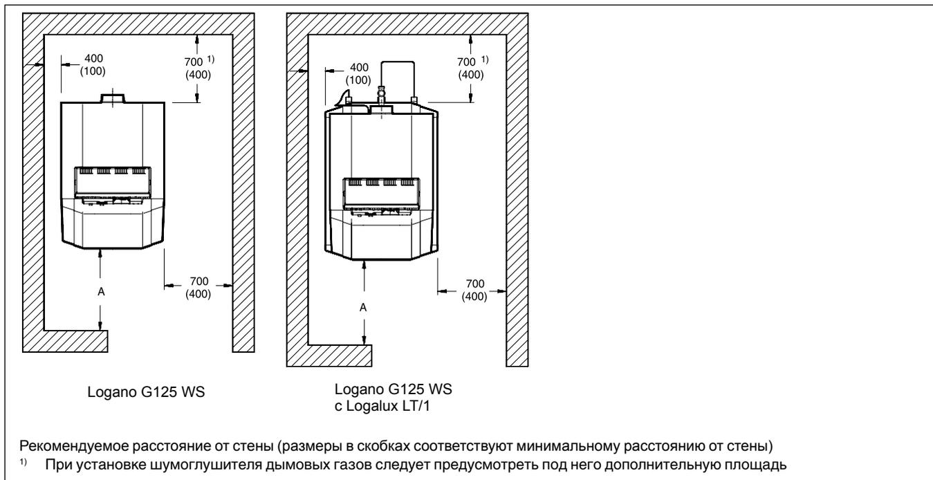
При установке отопительного котла следует соблюдать приведенные минимальные расстояния (указаны в скобках). Для удобства проведения монтажных, сервисных работ и технического обслуживания необходимо выдерживать рекомендуемые расстояния от стен.
