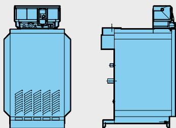
Настройка: заводская установка на природный газ E, переналадку на сжиженный газ P осуществляет заказчик, используя детали для перенастройки (дополнительная комплектация)
