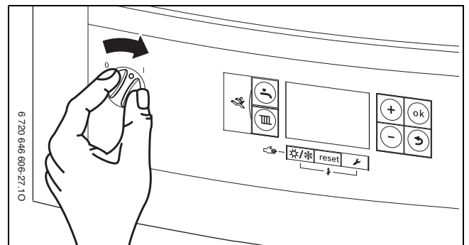
Рис. 26 Главный выключатель питания
