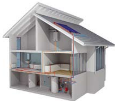
Горячая вода и отопление от гелиосистемы
