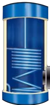
Бак ГВС косвенного нагрева (в разрезе)
