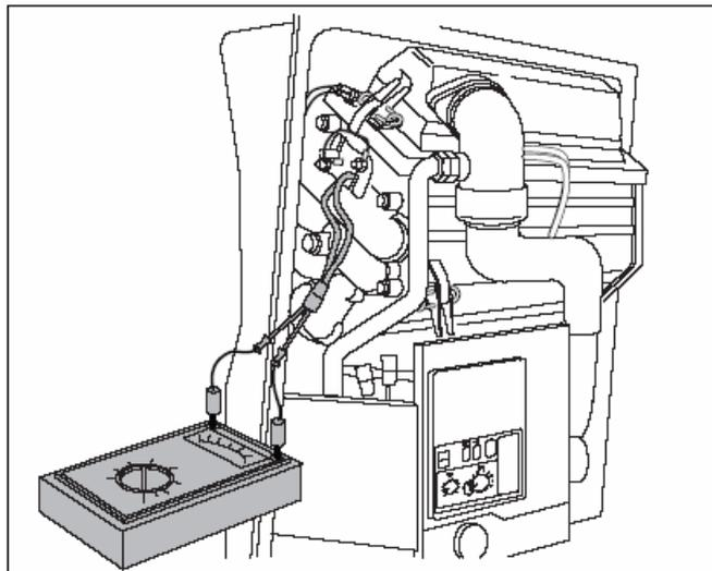
Рис. 30 Проверка калильного запального электрода
