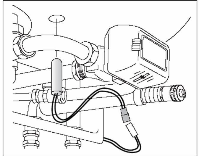
Рис. 24 Замена датчика водопроводной воды
