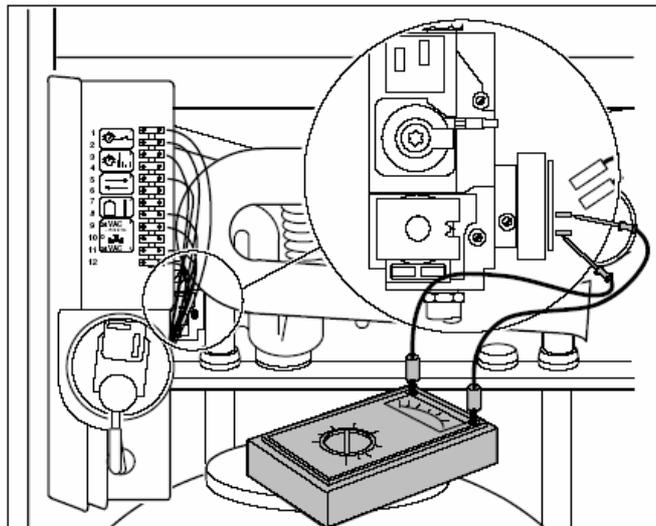
Рис. 37 Проверка устройства контроля давления газа
