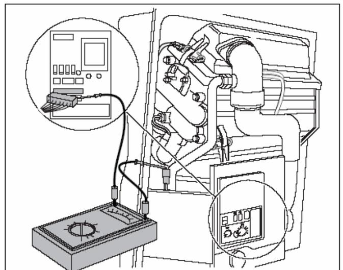
Рис. 26 Проверка кабеля к датчику защиты
