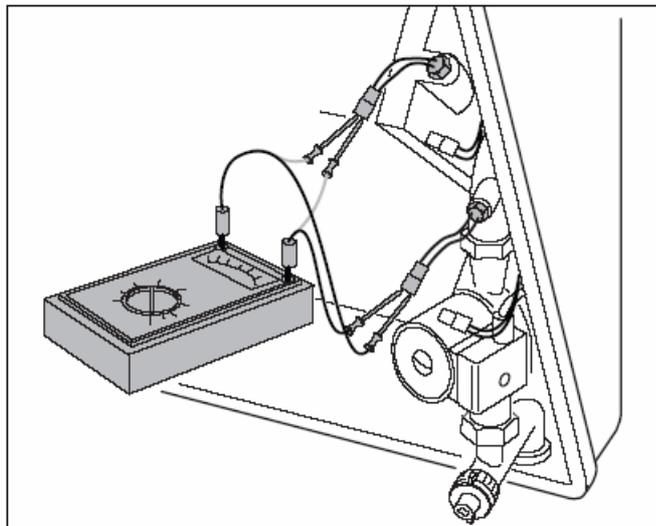
Рис. 20 Проверка датчиков прямой/обратной воды
