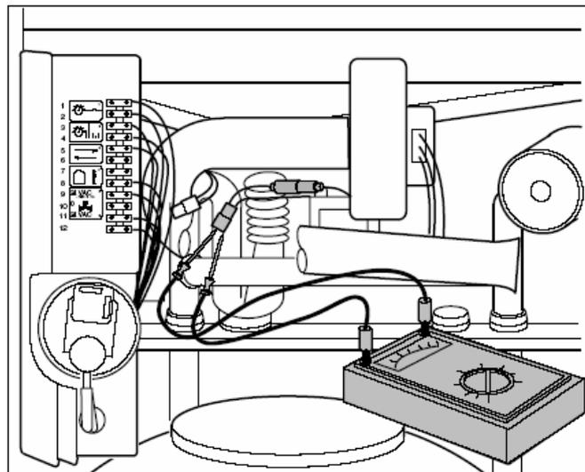
Рис. 13 Проверка трансформатора
