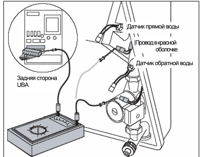
Рис. 25 Проверка кабеля к датчикам прямой/обратной воды
