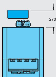
Максимальная высота с баком под котлом - 2028 мм, без бака - 1373 мм <sup>1)</sup>
