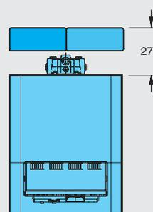
Максимальная высота с баком под котлом и с гребенкой HKV 2/32 - 2158 мм (HS/HSM 25, HS/HSM 20) и 2028 мм (HS/HSM 32). Максимальная высота без бака под котлом - 1503 мм (HS/HSM 25, HS/HSM 20) и 1553 мм (HS/HSM 32) <sup>1)</sup>
