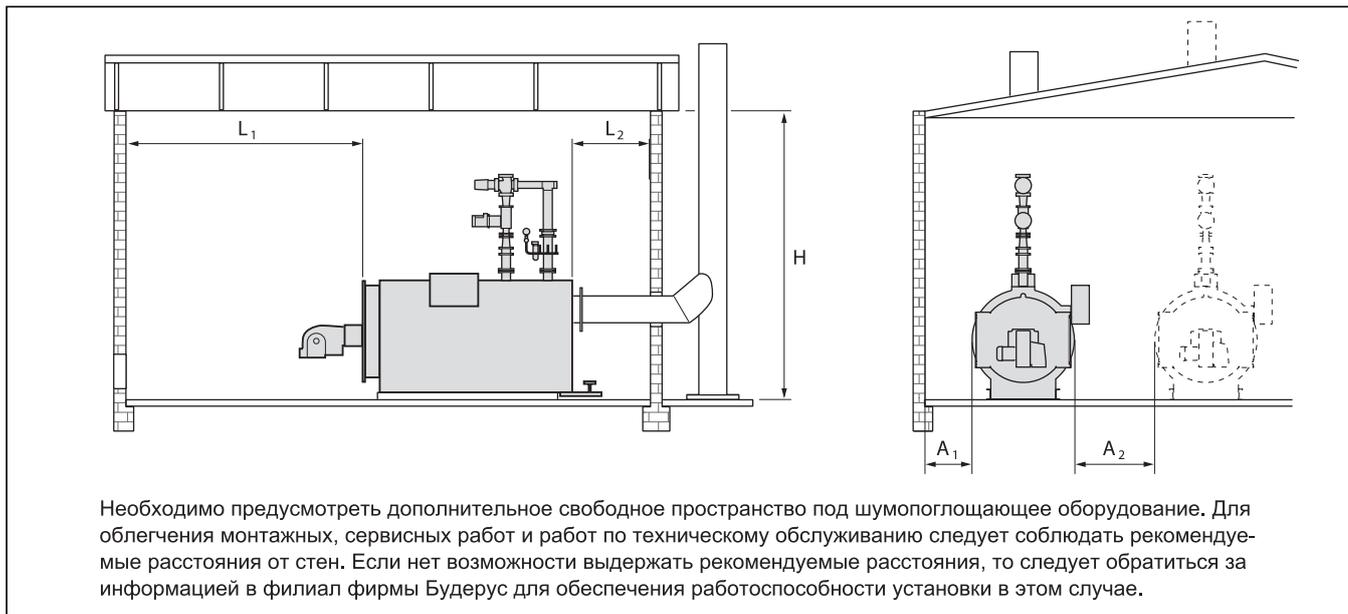
Необходимо предусмотреть дополнительное свободное пространство под шумопоглощающее оборудование. Для облегчения монтажных, сервисных работ и работ по техническому обслуживанию следует соблюдать рекомендуемые расстояния от стен. Если нет возможности выдержать рекомендуемые расстояния, то следует обратиться за информацией в филиал фирмы Бuderус для обеспечения работоспособности установки в этом случае.
