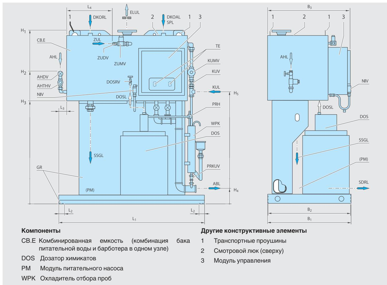
Размеры и подключения сервисного модуля воды WSM-T.E для установок 2000 кг/час
