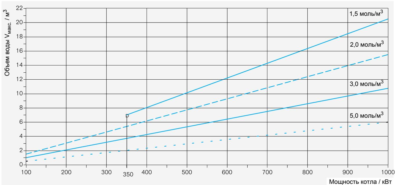
Расчетный объем воды  $V_{\text{макс}}$  для котлов  $\dot{Q} > 100 \text{ кВт}$  до  $\dot{Q} = 1000 \text{ кВт}$  и различных концентраций  $\text{Ca}(\text{HCO}_3)_2$ , моль/м<sup>3</sup>
