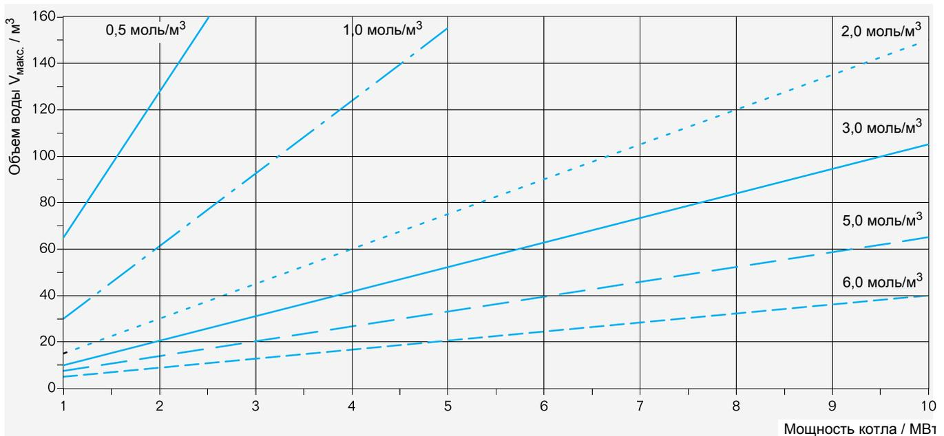
Расчетный объем воды  $V_{\text{макс}}$  для котлов  $\dot{Q} > 1 \text{ МВт}$  до  $\dot{Q} = 10 \text{ МВт}$  и различных концентраций  $\text{Ca}(\text{HCO}_3)_2$ , моль/м<sup>3</sup>
