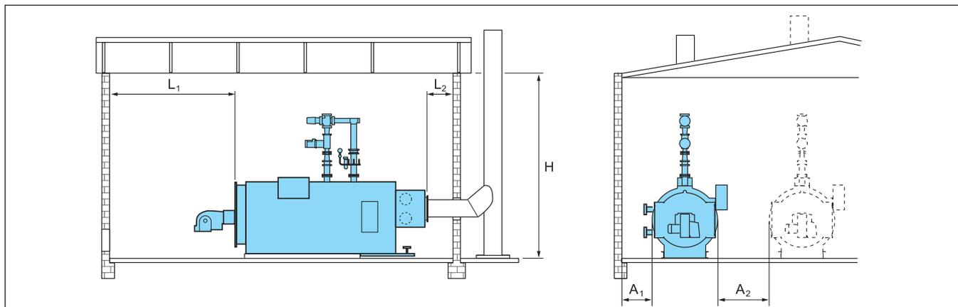
Необходимо предусмотреть дополнительное свободное пространство под шумопоглощающее оборудование. Для облегчения монтажных, сервисных работ и работ по техническому обслуживанию следует соблюдать рекомендуемые расстояния от стен. Если нет возможности выдержать рекомендуемые расстояния, то следует обратиться за информацией в филиал фирмы Бuderус для обеспечения работоспособности установки в этом случае.
