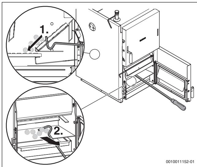
Рис. 8 Чистка решёток через дверь топочной камеры
