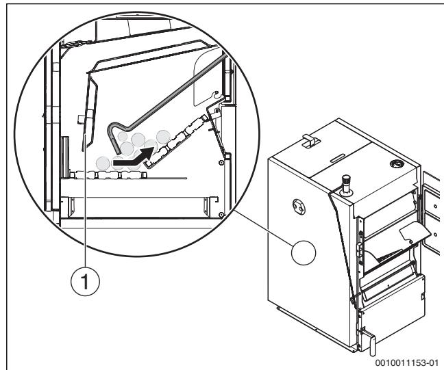
Рис. 9 Ворошите угли и очищайте пространство под пластиной
