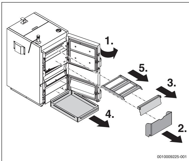
Рис. 13 Выемка турбулятора
